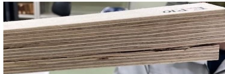
破壊形態もほとんどが積層方向中央部の木部せん断破壊
